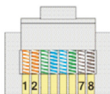
Detalle del conector RJ 45 (8x8) Vista Frontal
