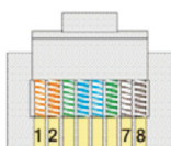
Detalhe do conector RJ 45 (8X8) Vista Frontal
